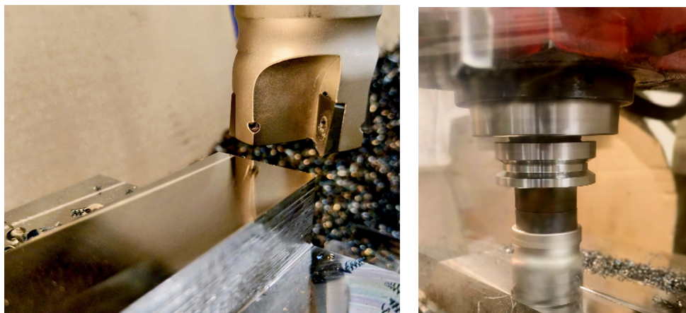
Рис. 3. Фрезерование плоскости и центральной выборки стальной заготовки Примечание: фото авторов
