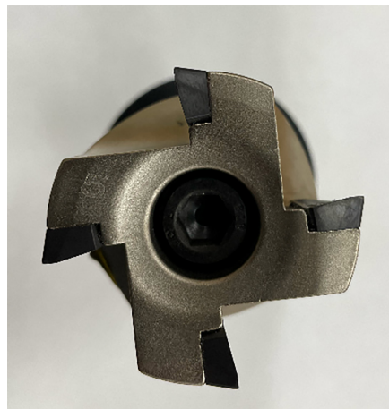
Рис. 1. Вид торцевой фрезы с четырьмя закрепленными режущими пластинами Примечание: фото авторов
