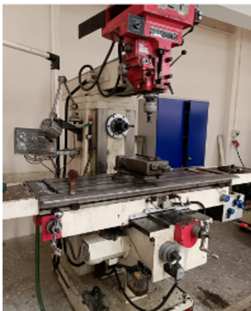
Рис. 2. Универсальный фрезерный станок 1452TS DRO Примечание: фото авторов
