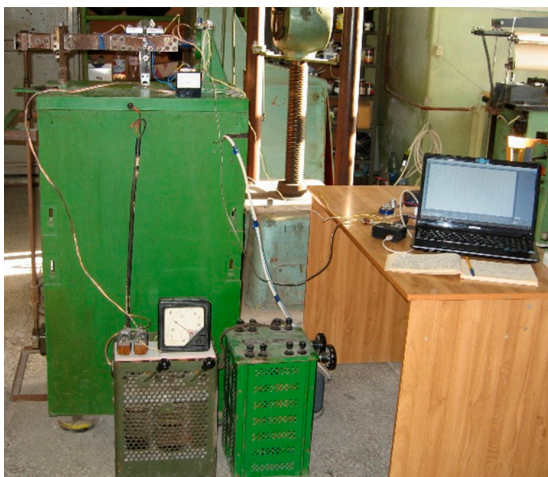
Рис. 2. Установка для усталостных испытаний образцов на циклический изгиб Примечание: составлен авторами по результатам данного исследования
