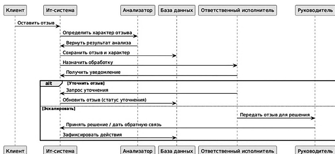
Рис. 2. Модель последовательностей действий компонентов автоматизированной системы обработки отзывов Примечание: составлен авторами по результатам данного исследования
