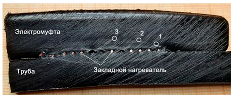
Рис. 1. Схема расположения исследуемых участков в сварном соединении Примечание: изображение получено авторами в рамках выполнения данного исследования
