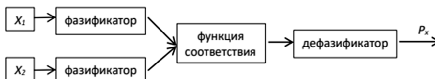
Рис. 1. Схема нечетко-ассоциативного метода ( X_1 и X_2 – сравниваемые величины, P_x – численный результат нечеткого сравнения) Примечание: составлен авторами на основе источника [9]
