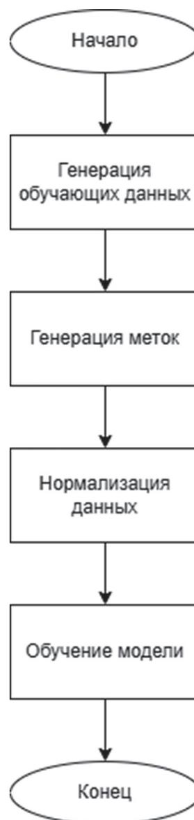
Рис. 3. Блок-схема метода предсказания вероятности дефекта
