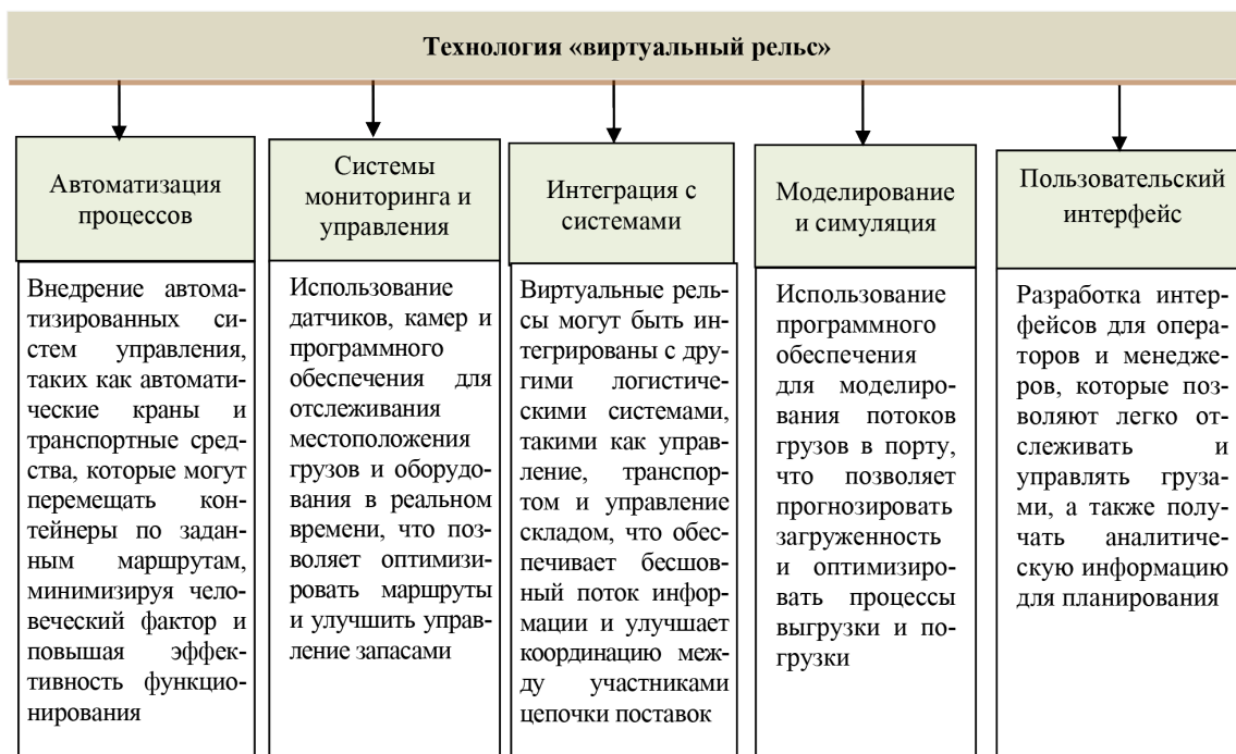
Рис. 1. Структура основных показателей технологии «виртуальный рельс»
