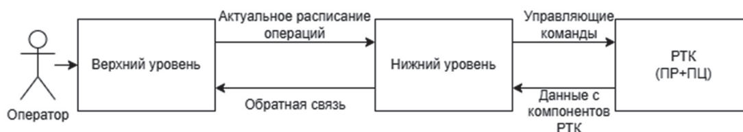
Рис.2. Схема метода переналадки мобильных компонентов РТК под изменяемые условия производственных процессов Источник: составлено авторами
