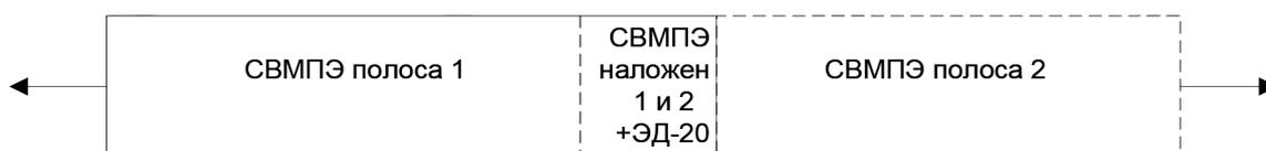
Рис. 1. Схема подготовки образца к испытаниям на разрыв
