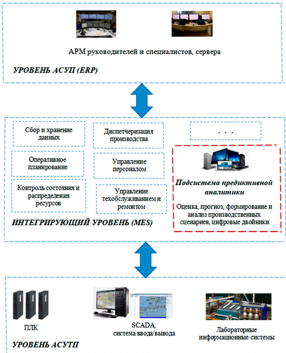
Рис. 2. Обобщенная схема интегрированной системы управления ОФ ГОК (взаимодействие АСУТП и АСУП) с включенной ППА Источник: составлено авторами на основе [4]
