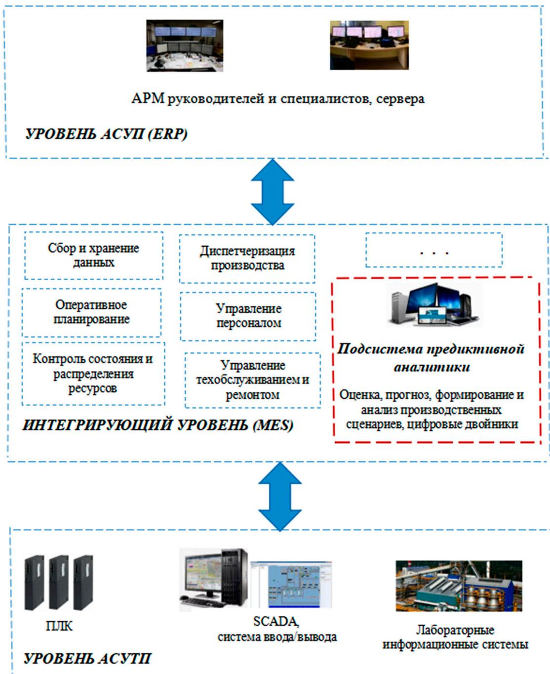
Рис. 2. Обобщенная схема интегрированной системы управления ОФ ГОК (взаимодействие АСУТП и АСУП) с включенной ППА
