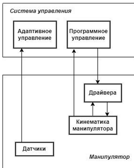
Рис. 1. Структурная схема системы управления робота-манипулятора
