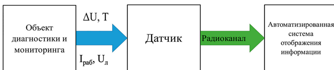
Рис. 2. Блок-схема системы на основе датчиков сопротивления соединительных муфт Источник: составлено авторами по результатам данного исследования
