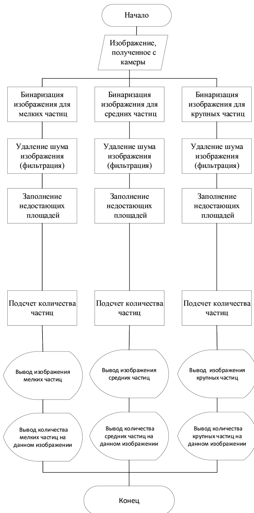
Рис. 2. Алгоритм оценки крупности по предварительной цветовой маркировке Источник: составлено автором
