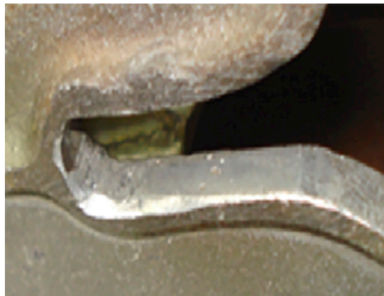
Рис. 3. Рабочая поверхность замка створки шасси с незначительным углублением
