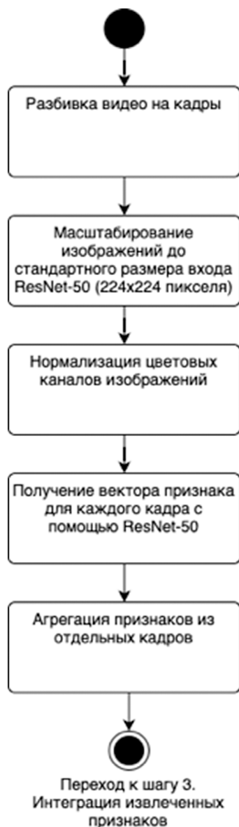
Рис. 1. Предобработка и извлечение признаков из видеоряда с использованием архитектуры сверточной нейронной сети ResNet-50
