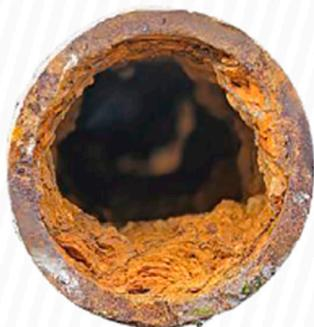
Рис. 2. Коррозионные повреждения трубопровода
