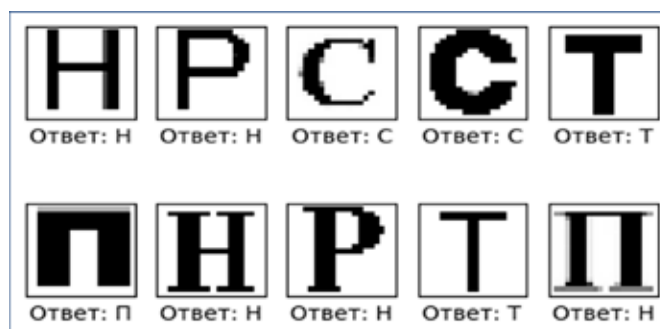
Рис. 8. Тестирование работы двухслойной нейронной сети на собственных изображениях
