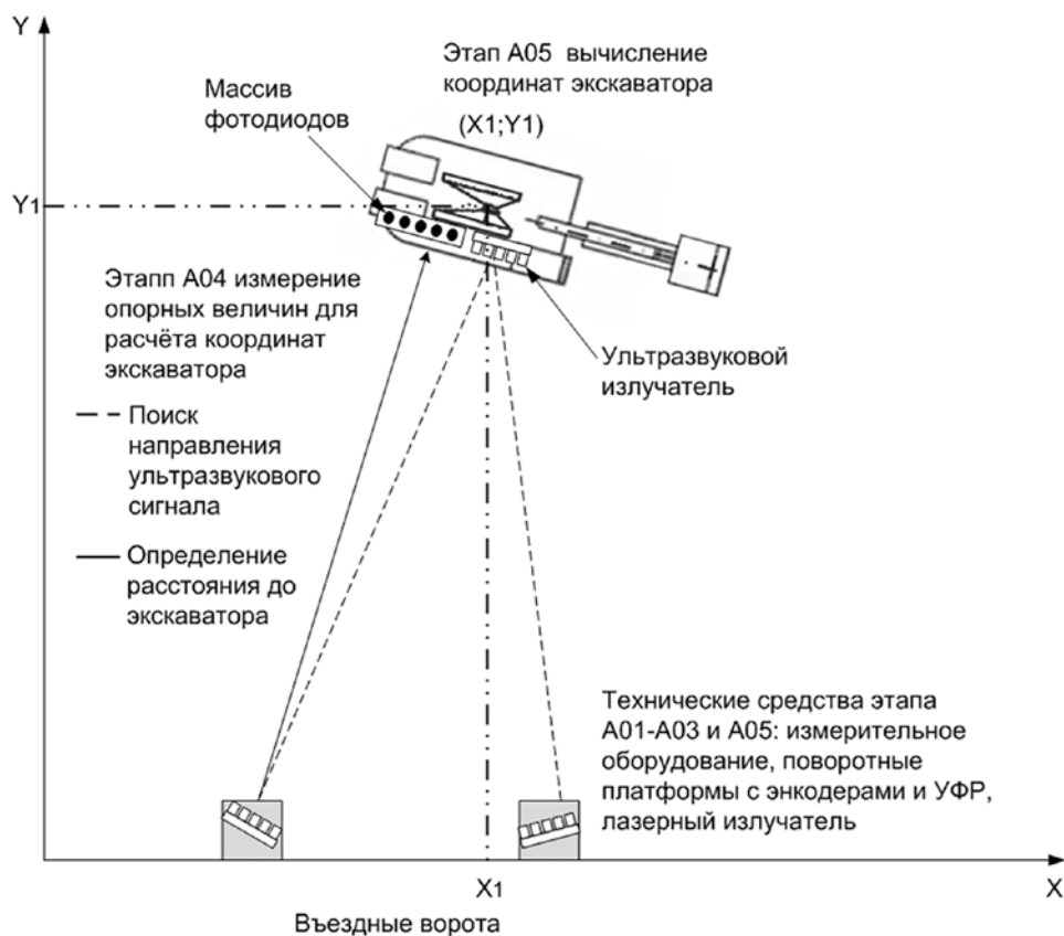
Рис. 5. Схема выполнения этапов определения местоположения экскаватора в забое
