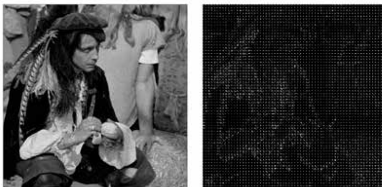
Рис. 2. Результат вычисления дискретного косинусного преобразования в блоках размером 8 \times 8 пикселей
