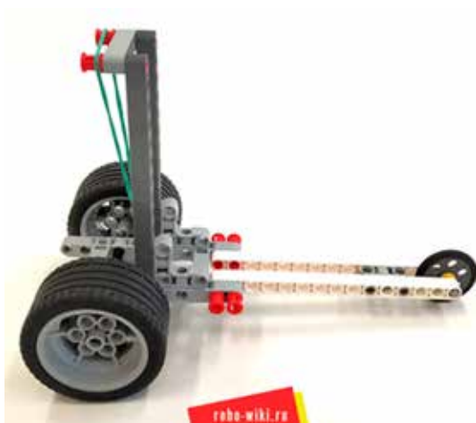
Рис. 3. Машинка на резиномоторе
