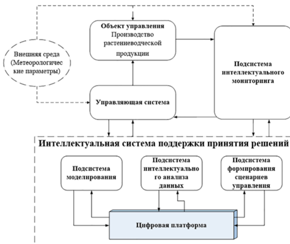
Рис. 2. Обобщенная модель автоматизированной системы управления производством растениеводческой продукции в условиях динамики ПЭ
