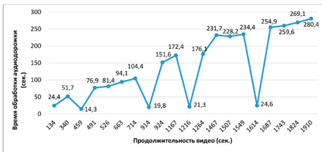
Рис. 2. График зависимости времени обработки аудиодорожки видео от его продолжительности
