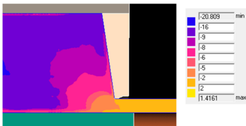
Рис. 5. Распределение показателя напряженного состояния \sigma/T в очаге деформации в виде цветных уровней с масштабной таблицей, верхняя часть очага деформации
