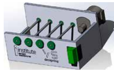
а) 3D-модель корпуса редуктора в сборе
