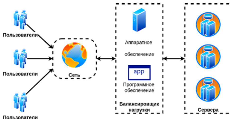
Рис. 1. Общая архитектура балансировщика нагрузки
