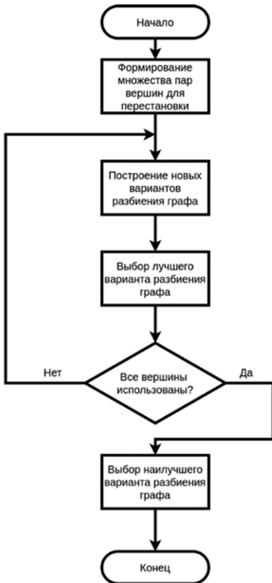
Рис. 2. Схема алгоритма Кернигана-Лина
