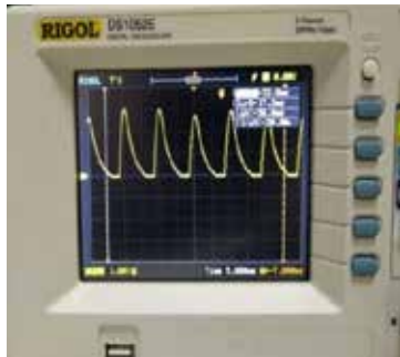
Рис. 1. Изменение импульсного напряжения U_a = 6В в межэлектродном промежутке при ААП сплава 32НҚД с режимами: A = 15–17 мм, f = 20 Гц, t_u = 3 мс
