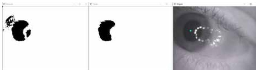
Рис. 4. Слева направо: результат пороговой бинаризации по найденному минимуму, результат фильтрации (нахождения кластера зрачка), найденный центр зрачка
