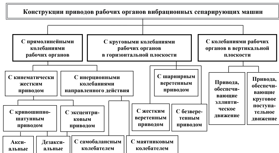
Рис. 2. Классификация конструкций приводов вибрационных сепарирующих машин
