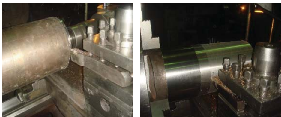
Рис. 4. Эксперименты на заготовке чугуна ИЧХ28Н2
