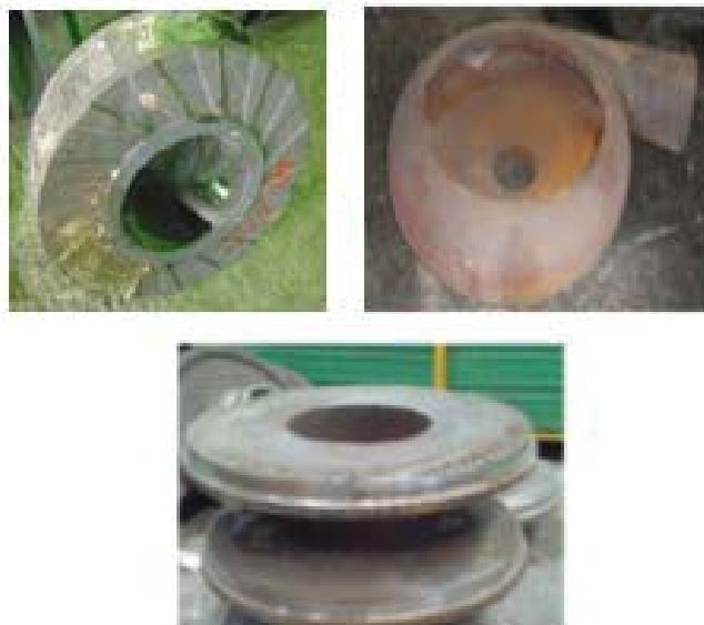
Рис. 1. Рабочее колесо, внутренний корпус, защитный диск насоса марки Грат-1400
