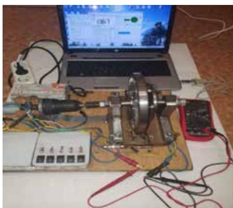
Рис. 1. Лабораторный стенд для изучения работы планетарного редуктора
