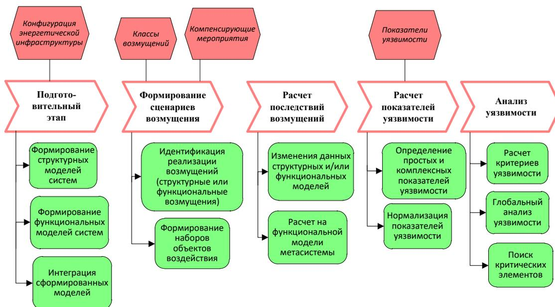
Рис. 2. Концептуальная схема анализа уязвимости энергетической инфраструктуры
