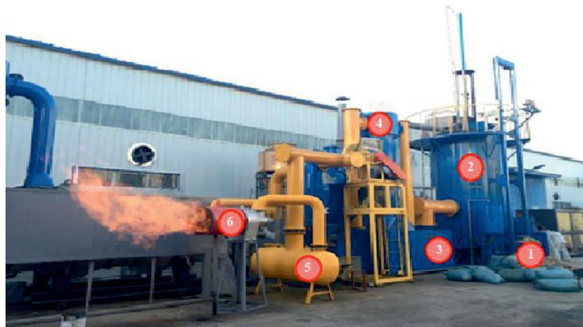
Рис. 1. Комплекс оборудования прямой газификации ТКО: 1 – загрузочное устройство, 2 – газогенератор, 3 – бак с водой, 4 – циклон, 5 – бак распределитель, 6 – факел генераторного газа
