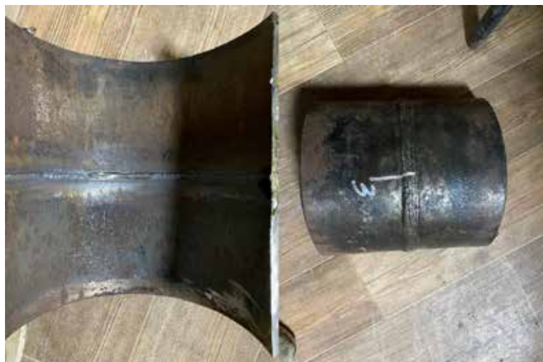
Рис. 4. Результат проведения разрушающего контроля
