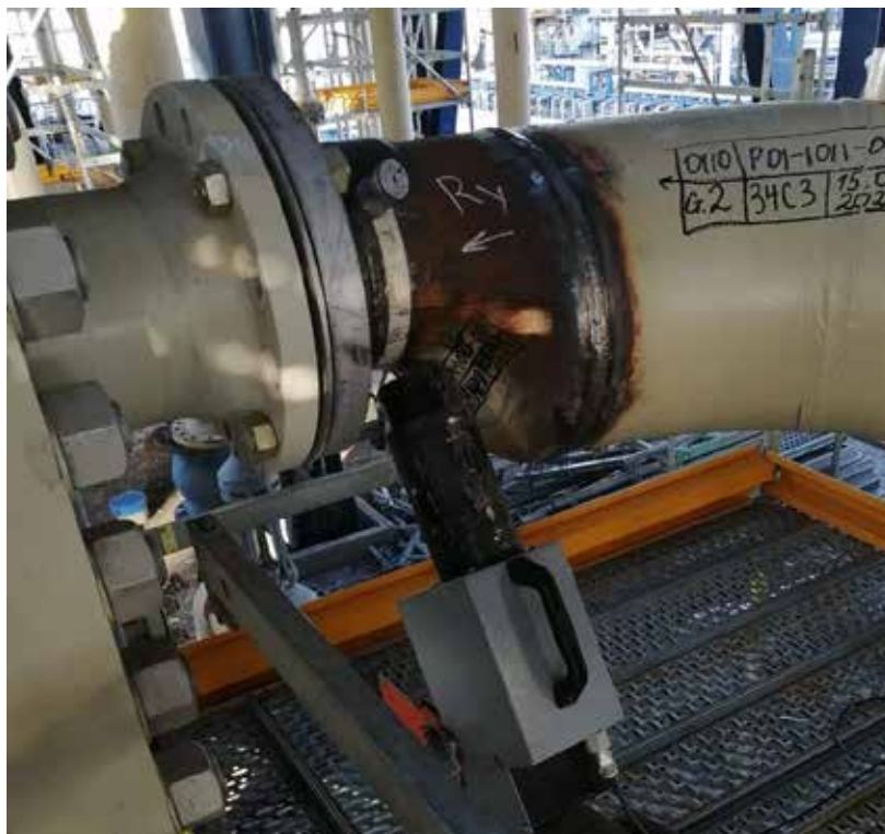
Рис. 2. Испытание аппарата «Памир-300» на произвольном стыковом сечении
