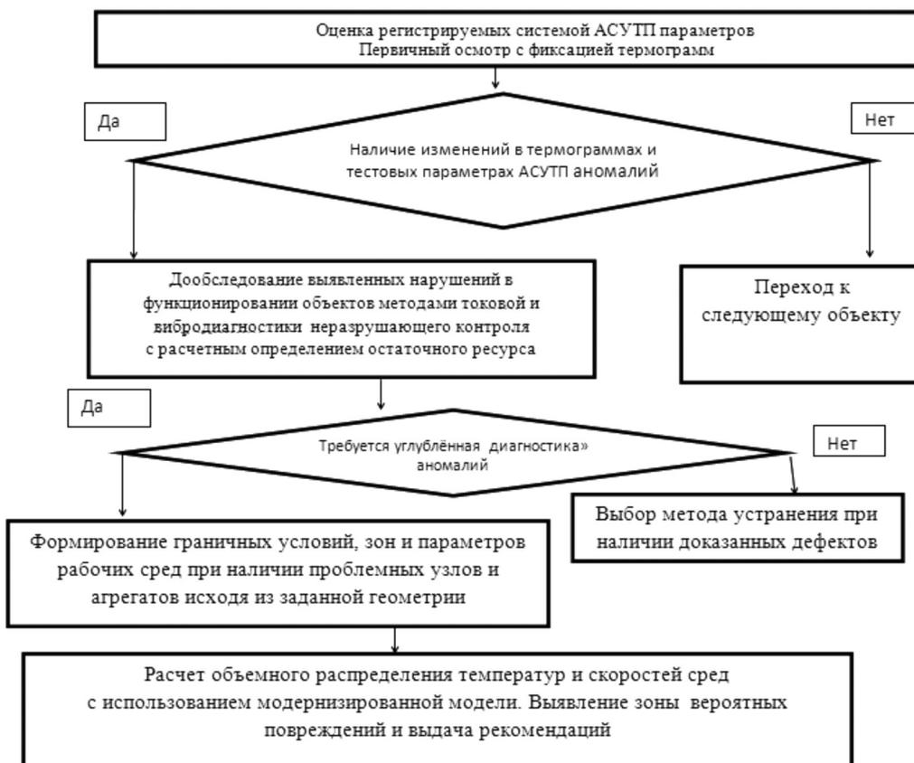
Рис. 1. Предлагаемый алгоритм первичной оценки состояния оборудования
