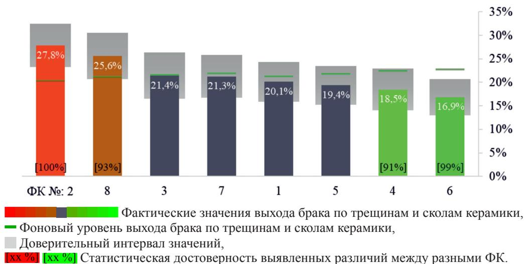
Рис. 3. Диаграмма оценки влияния выбора формовочного комплекта на выход брака по трещинам и сколам керамики по данным сплошной выборки заготовок, изготовленных в течение трехлетнего периода (номера формовочных комплектов указаны под столбиками диаграммы)
