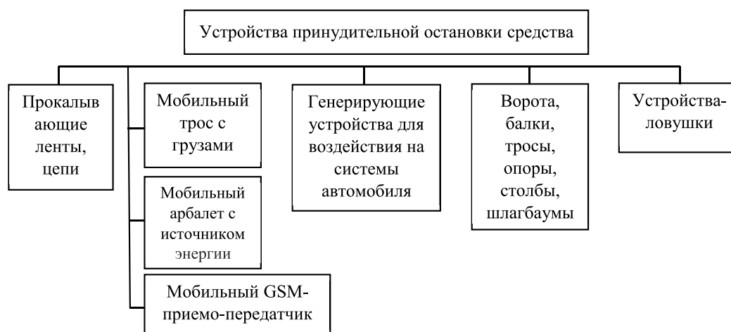
Рис. 2. Классификация средств принудительной остановки транспорта по типу применяемых устройств для остановки транспортных средств
