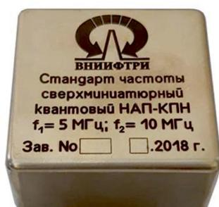
Рис. 1. Внешний вид стандарта частоты сверхминиатюрного квантового НАП-КПН
