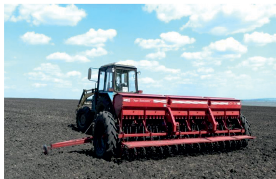
Рис. 2. Общий вид сеялки СЗ-5,4-0,6 с экспериментальными сошниками
