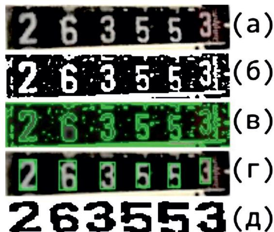
Рис. 4. а) исходное изображение циферблата, б) изображение циферблата, полученное с помощью пороговой бинаризации, в) изображение с выделенными контурами, г) изображение с помеченными прямоугольниками с цифрами, д) полученные цифры в бинарном виде
