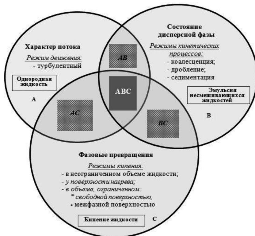
Рис. 2. Комбинации взаимосвязанных механизмов переноса теплоты
