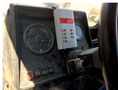
Рис. 3. Место установки прибора регистрации и вычисления эксплуатационно-технологических параметров погрузочного агрегата
