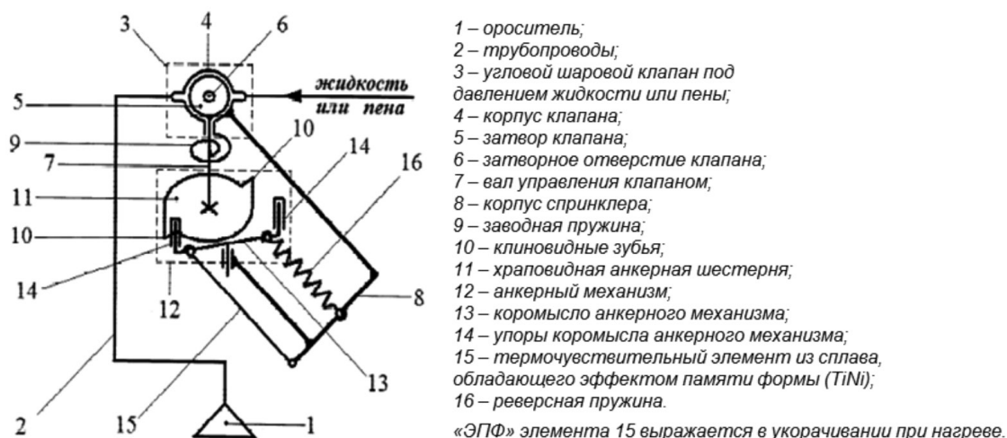
Рис. 1. Конструкция спринклера
