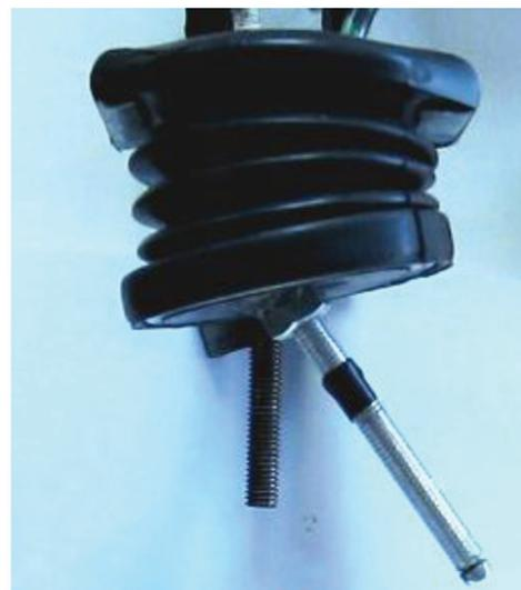
Рис. 4. Вакуумный сильфонный приводной механизм: а) схема устройства; б) общий вид
