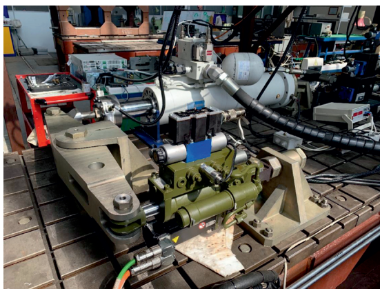
Рис. 3. Экспериментальная установка гибридного электрогидравлического рулевого привода
