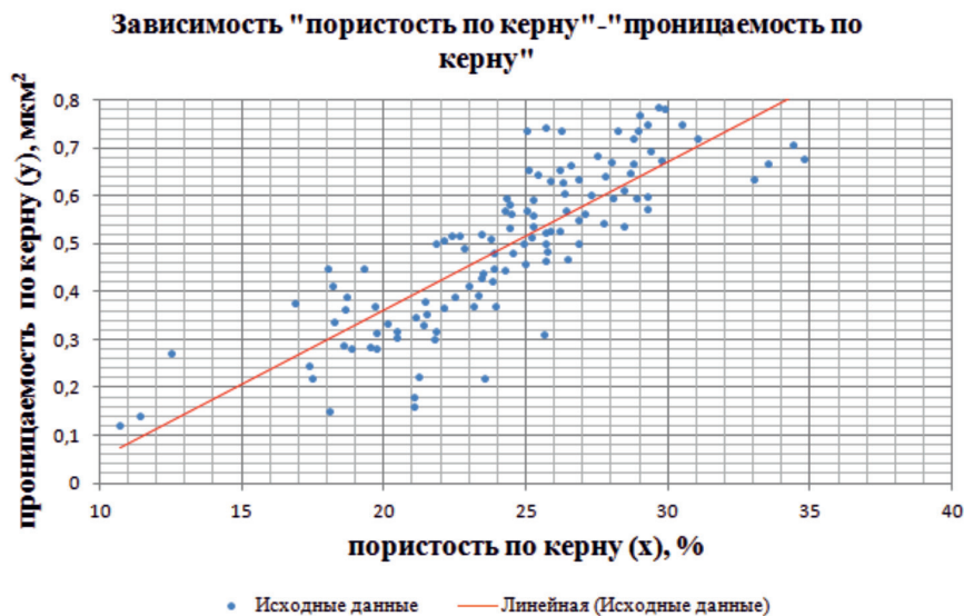
Рис. 1. Исходные данные отношения «пористость по керну ( x ) – проницаемость по керну ( y )», полученные по трем скважинам. Точками обозначены значения одновременно измеренных параметров, красной линией – линейная регрессия для исходных данных
