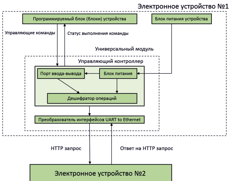
Рис. 2. Функциональная схема универсального модуля в составе электронного устройства
