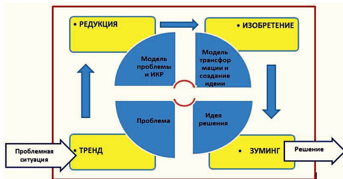
Рис. 1. Метаалгоритм изобретения Т-Р-И-З: Тренд – анализ проблемной ситуации, установление цели и определение направления развития конструкции; Редукция – построение модели проблемы в форме противоречия; Изобретение – создание идеи с помощью моделей трансформации; Зуминг – рассмотрение идеи в разном масштабе (с разных уровней – зуминг) для оценки эффективности
