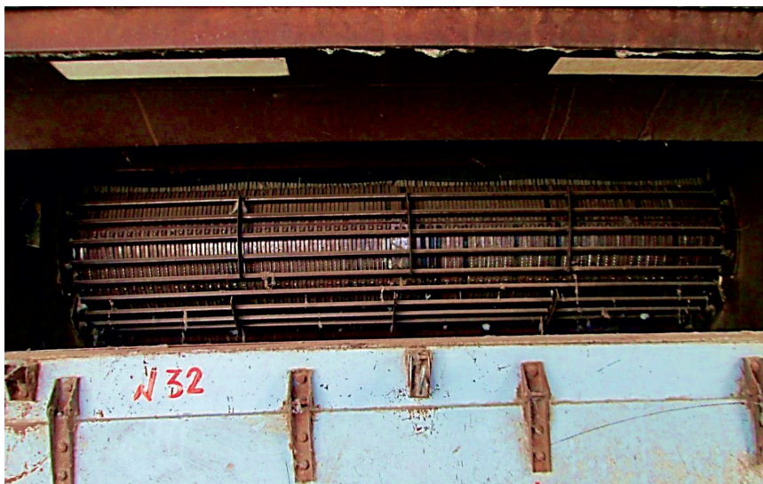
Рис. 3. Колосниковая решетка очистителя хлопка от крупного сора ЧХ-3М2
