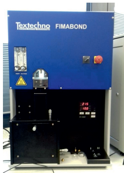
Рис. 1. Фото машины для изготовления образцов при проведении испытаний методом pull-out
