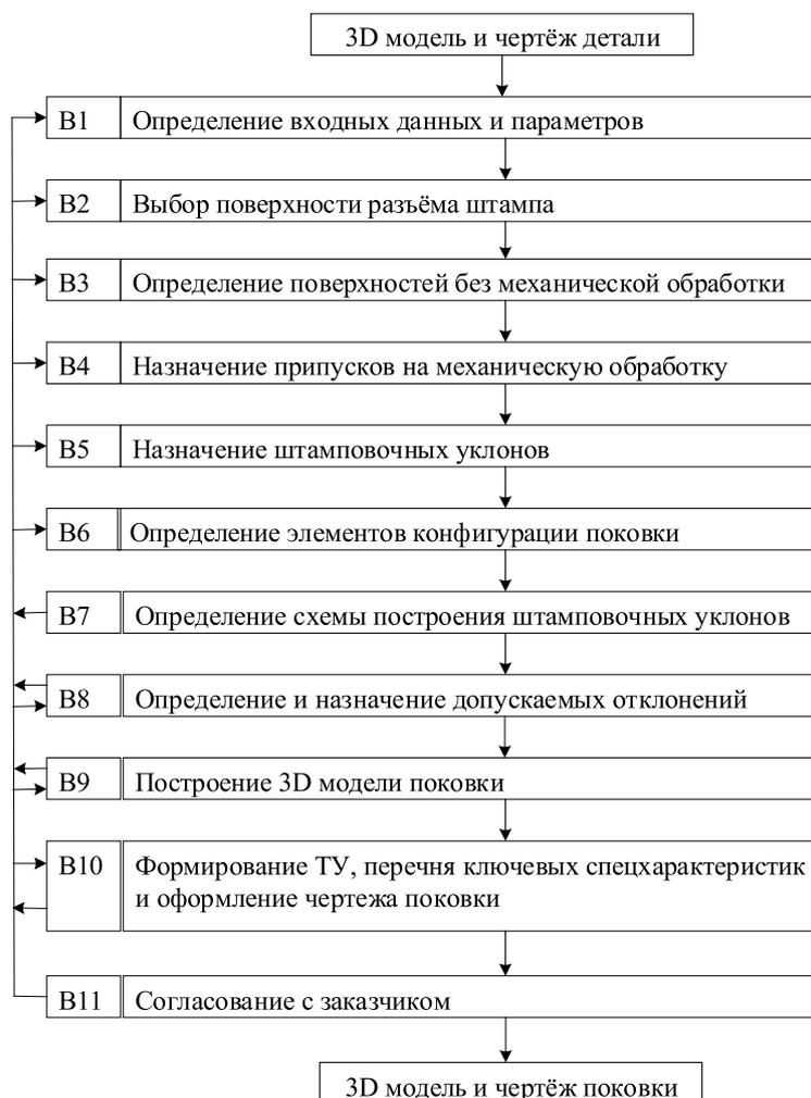
Рис. 3. Этапы разработки чертежа поковки
