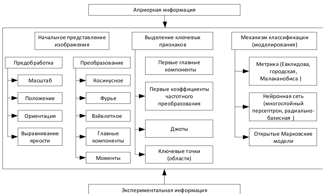
Рис. 2. Обобщенная схема методов распознавания образов и изображений
