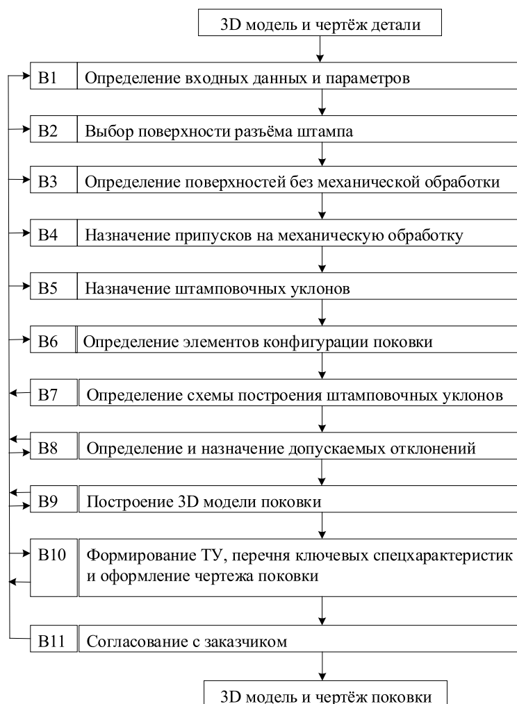
Рис. 3. Этапы разработки чертежа поковки
