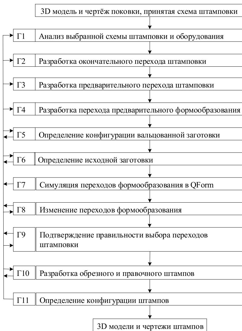
Рис. 4. Проектирование технологических переходов формообразования поковки и штамповой оснастки
