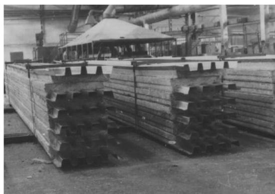
Рис. 1. Панель кровельная двуслойная
