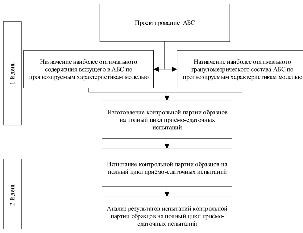
Рис. 2. Принципиальная схема проектирования асфальтобетонной смеси
