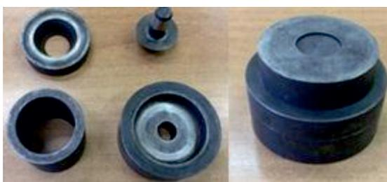
Рис. 1. Оправка для осаждения заготовок в процессе ВТМО
