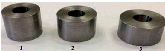
Рис. 2. Заготовки для изготовления опытных образцов: образец 1 – Ст45 (ГОСТ 1050-88),  $D_1 = 33$  мм  $h_1 = 27$  мм,  $V = 21$  см<sup>3</sup>; образец 2 – Ст45 (ГОСТ 1050-88),  $D_1 = 36$  мм  $h_1 = 23$  мм,  $V = 21$  см<sup>3</sup>; образец 3 – Ст45 (ГОСТ 1050-88),  $D_1 = 38$  мм  $h_1 = 21$  мм,  $V = 21$  см<sup>3</sup>
