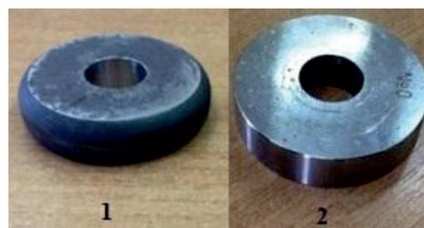
Рис. 3. Образец 1 Ст45 после ВТМО, образец 2 Ст45 после ТО
