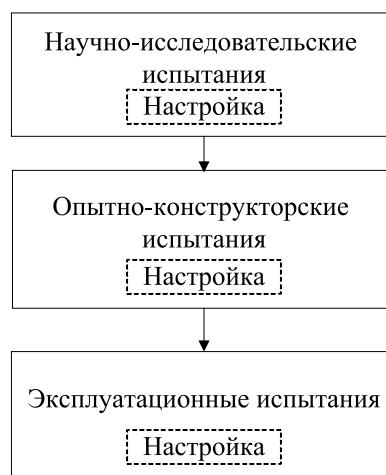
Рис. 2. Этапы испытаний САУ ГТУ
