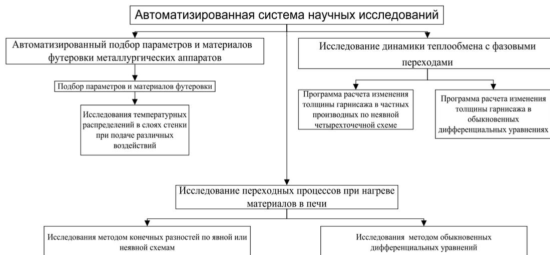
Рис. 1. Структура программного комплекса
